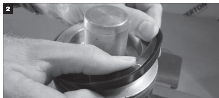
Sujete el pistón con firmeza, coloque el sello en la ranura y utilice presión dactilar para comenzar a estirarlo sobre la cabeza del pistón.
